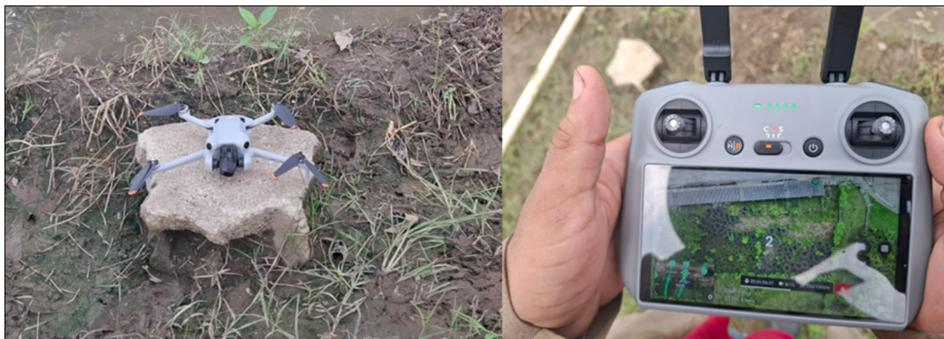
Figura 2. Vehículo aéreo no tripulado (VANT) marca DJI modelo Mini Pro 4 (izquierda) y control DJI RC2 con pantalla integrada y app DJI Fly (derecha).
