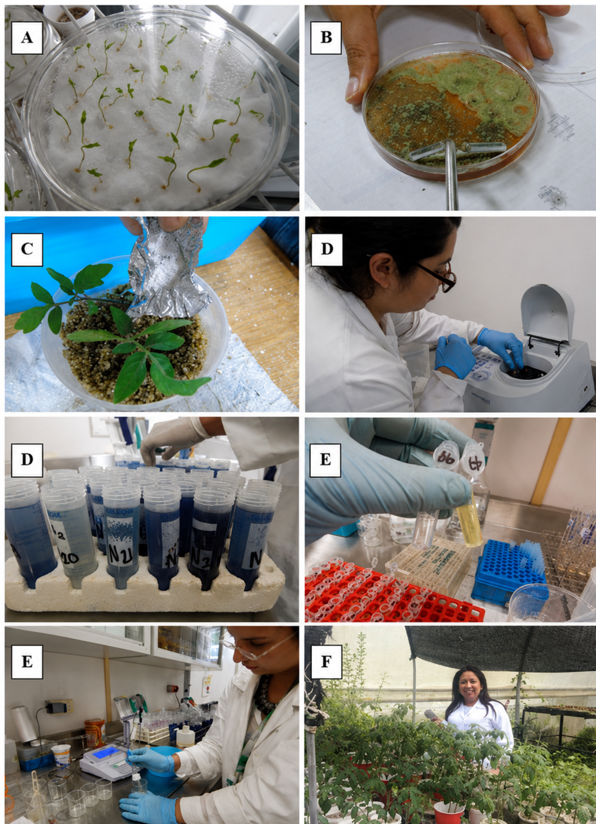
Figura 2. Metodología aplicada en el desarrollo del estudio, A) desinfección y germinación de semillas de jitomate, B) preparación del bioinoculante fúngico, C) aplicación del fosfato tricalcico al sustrato, D) medición de fósforo soluble al espectrofotómetro, E) medición de enzimas fosfatasas, F) plantas de jitomate en el invernadero.
